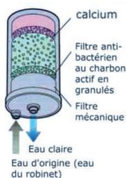
Une eau délicieuse diffusée au travers d'un filtre à 3 couches à haut pouvoir filtrant.
